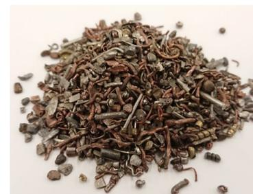
自動車シュレッダーダスト(ASR)の最終残渣から回収された金属類。濃縮された貴金属滓として金、銀、銅、パラジウムが回収される。
